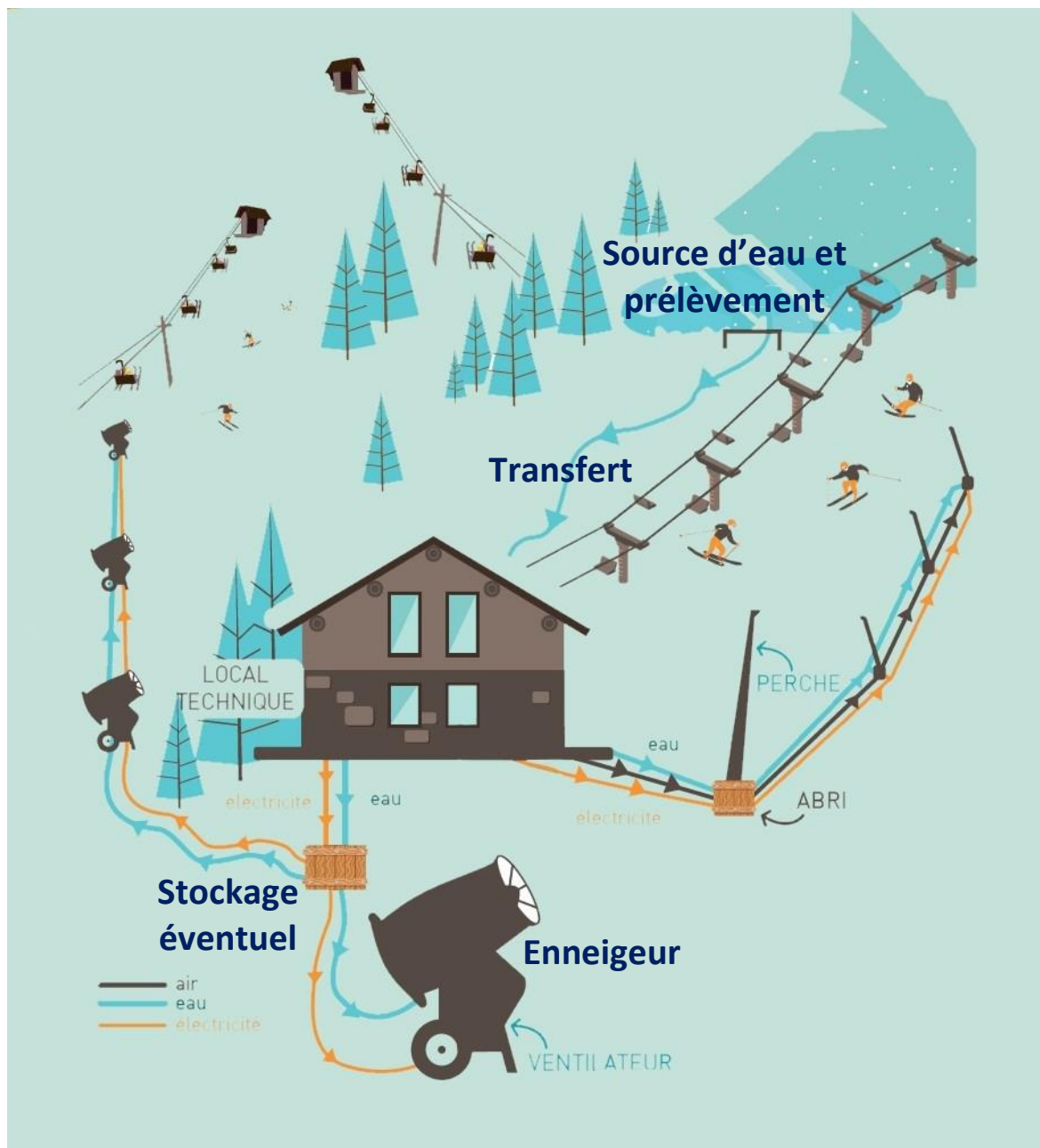
Schéma de principe d'une installation de production de neige de culture
